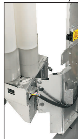
Fácil acesso interno, graças à abertura de 180° da torre de copos.
